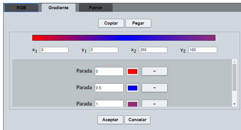
Figura 15.2: Pestaña Gradiente de la herramienta de control de colores.
