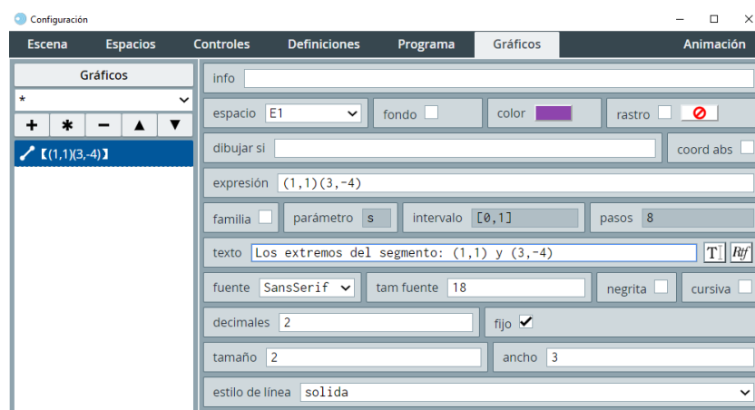
Figura 8.9: Configuración para el ejemplo del gráfico Segmento . El color usado es 8E44AD.
